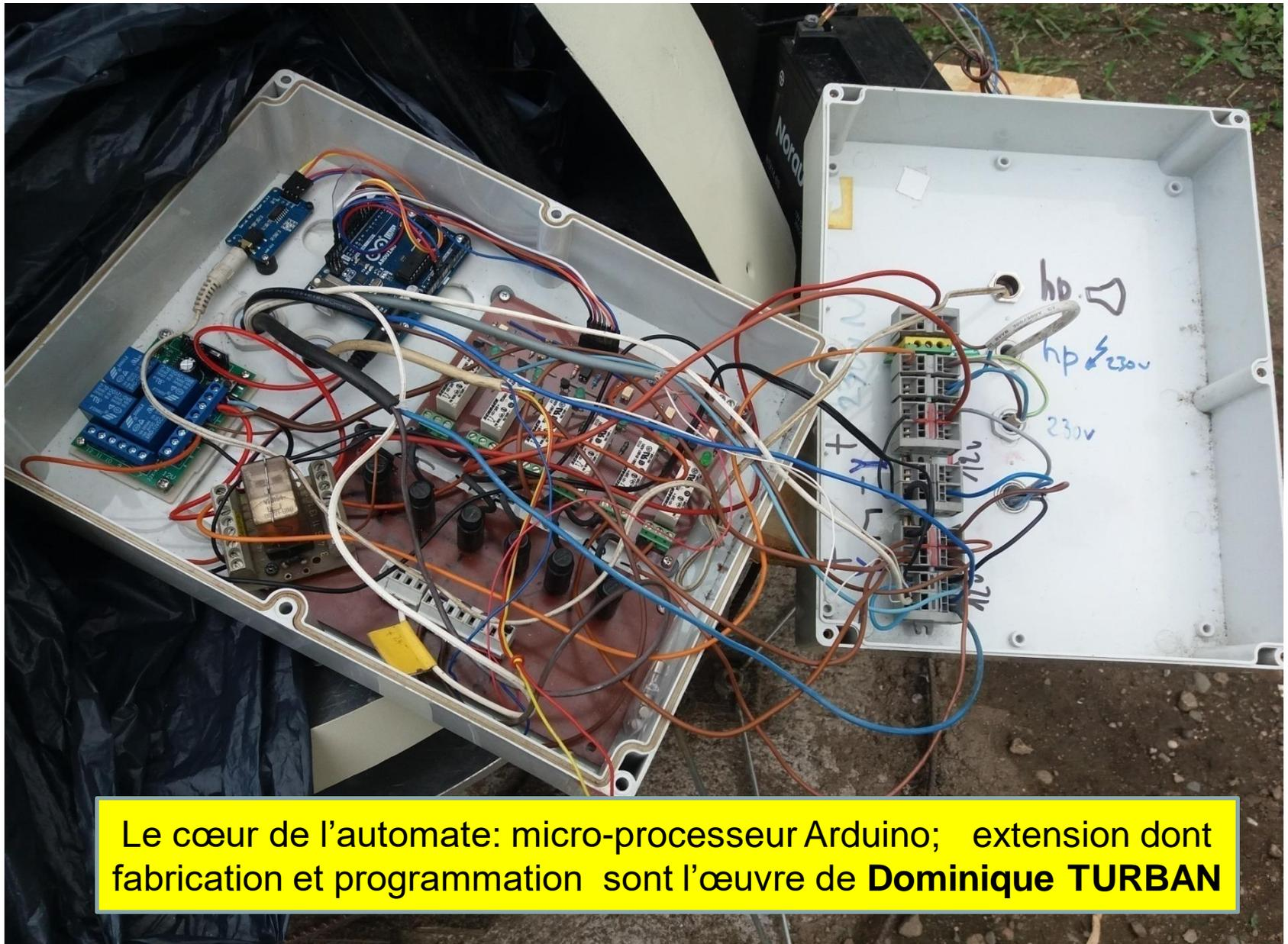
Le cœur de l'automate: micro-processeur Arduino; extension dont fabrication et programmation sont l'œuvre de **Dominique TURBAN**
