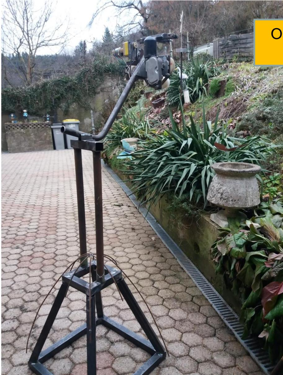
Ossature mécano-soudée en tubes d'acier et fers à béton
