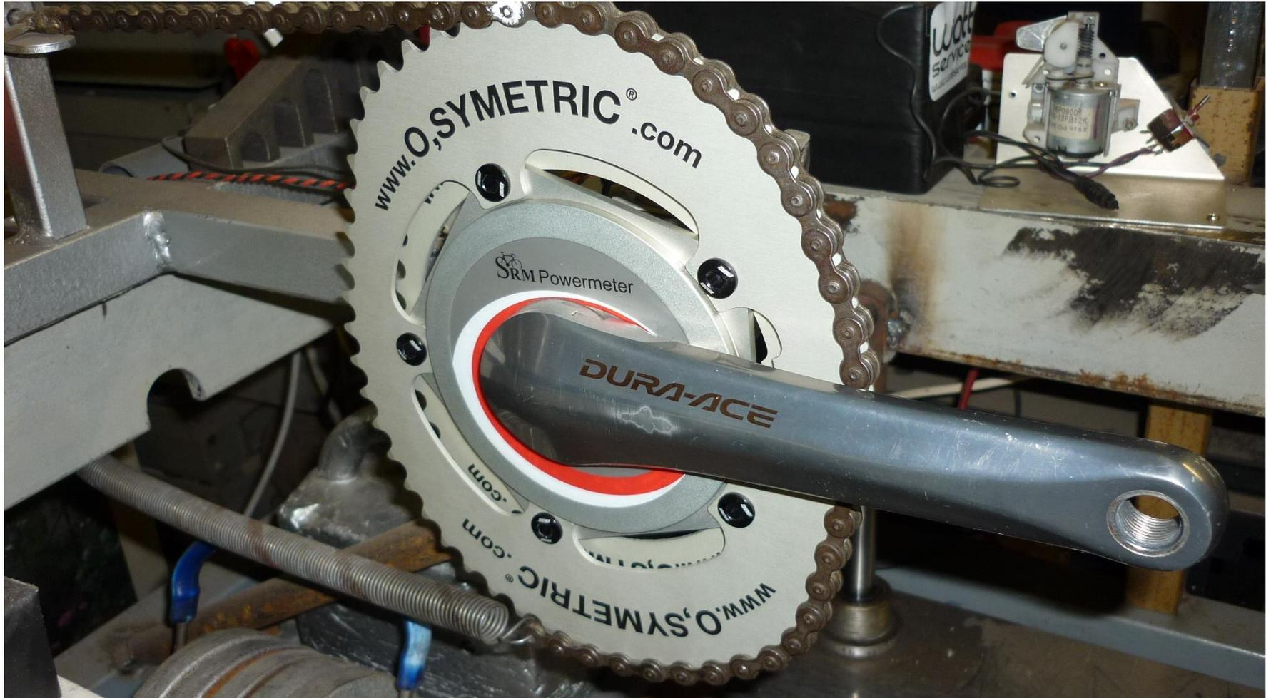
Pédalier SRM sur le banc stato-dynamique en vue de son étalonnage
